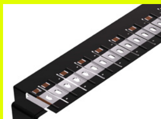
集成方形电芯电池互连系统的FDC技术
